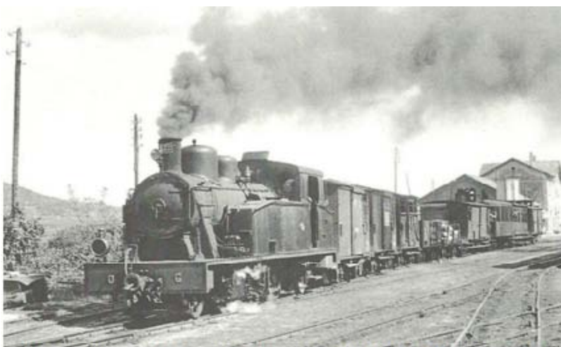
Tren mixto, con locomotora de vapor MZA-701/740, construida por Maffei en 1903. Estacion sin edentificar año 1910.
